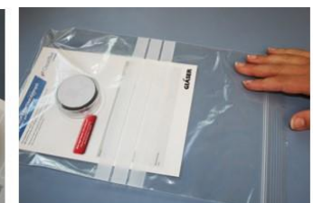
Partikelstempel schließen und saubereitgerecht zur mikroskopischen Analyse transportieren Close particle stamp and transport it according to cleanliness requirements to microscopic analysis
