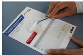
Schutzfolie mit Pinzette entfernen Remove adhesive label with tweezers
